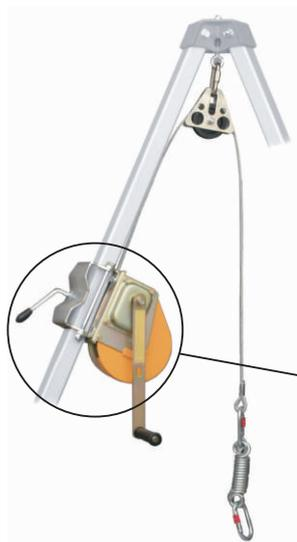
Possibilità di installazione del **verricello art.0284 o 028401** (lunghezza cavo 20 m o 25 m). Carico massimo di lavoro: 140kg. Fornito separatamente; completo di puleggia e connettori.
